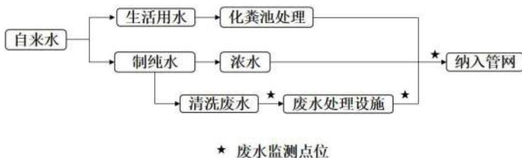
图 4-1 废水治理工艺流程和监测点位图
