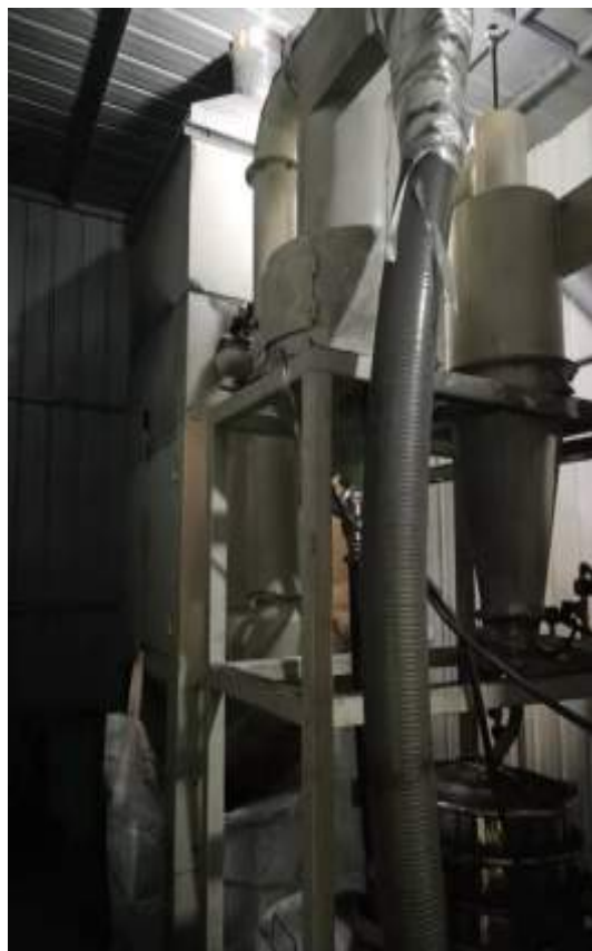
喷砂废气排气筒及除尘处理设施
