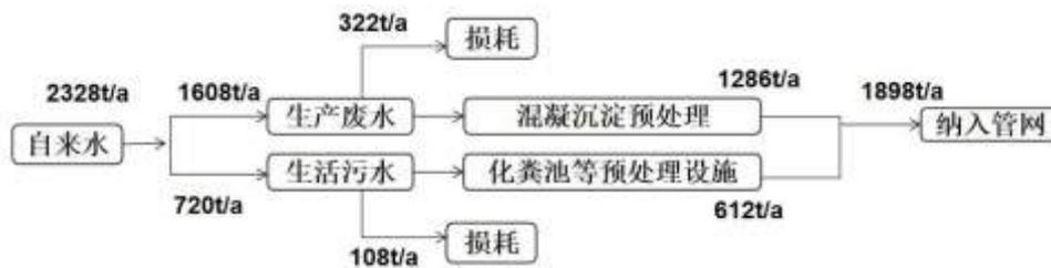
图 3-3 水量平衡图
