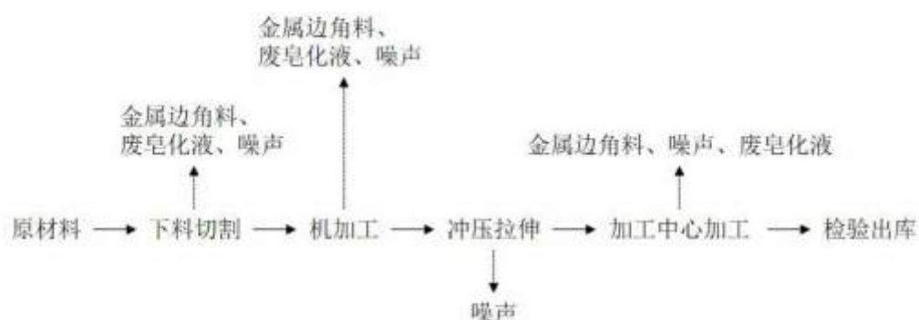
图 3-3 生产工艺流程及产污环节图
