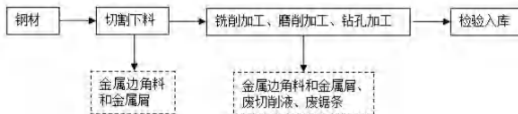
图 3-4 生产工艺流程及产污环节图
