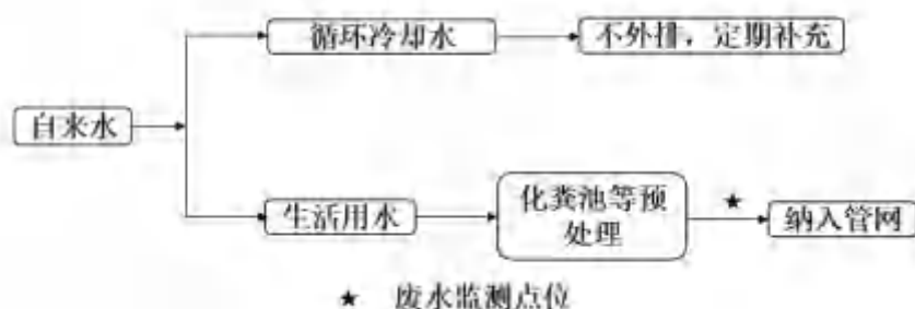
图 4-1 废水治理工艺流程和监测点位图
