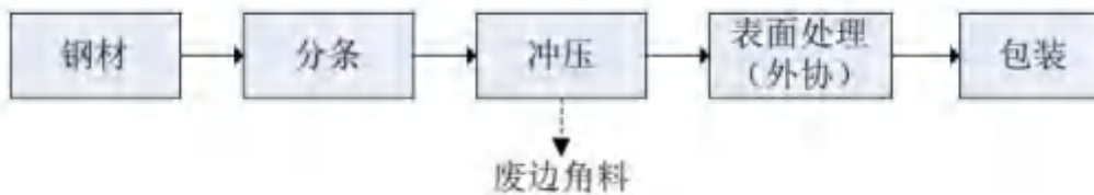
图 3-7 法兰角生产工艺流程及产污环节图
