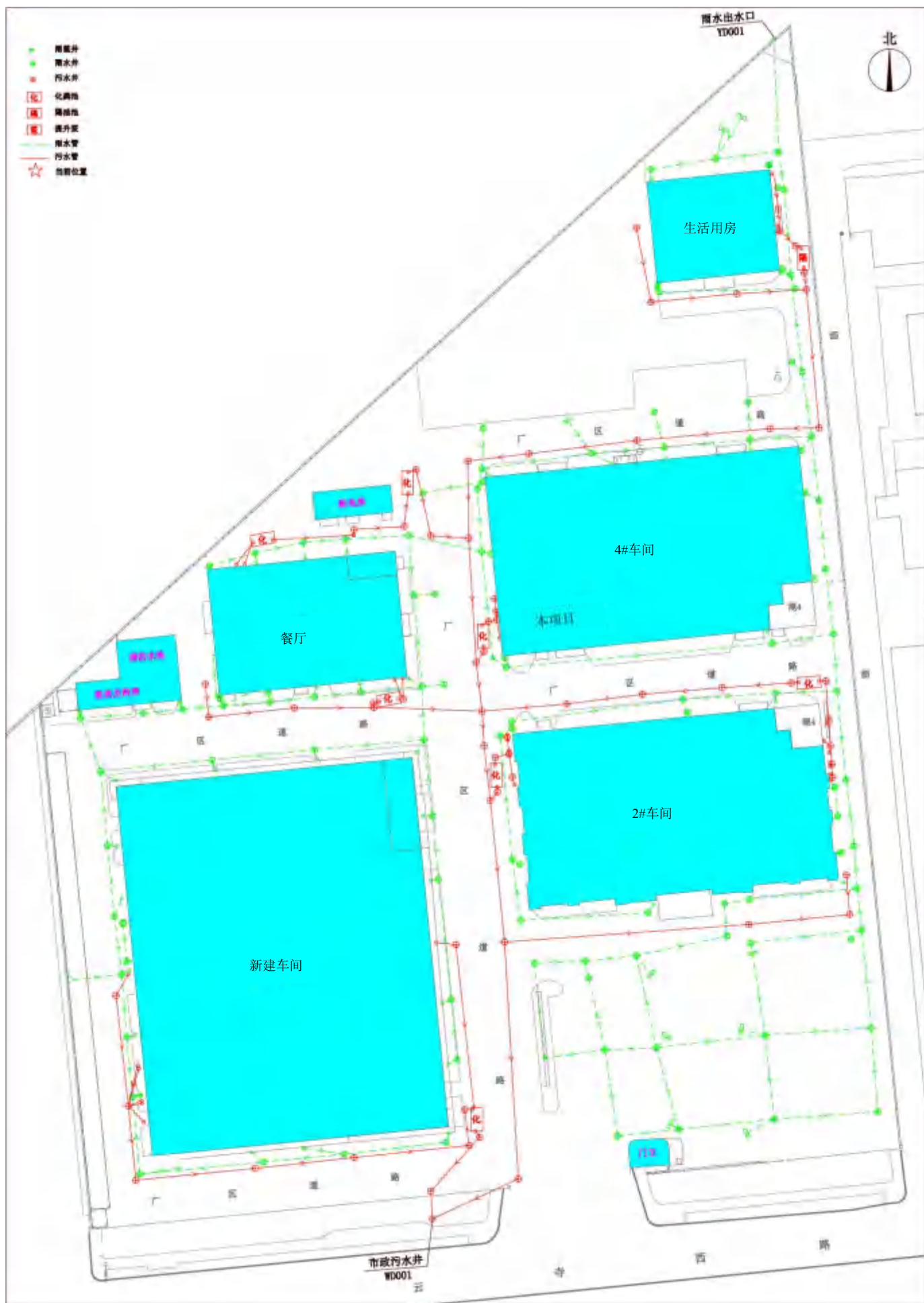
附图 1 雨污管线图
